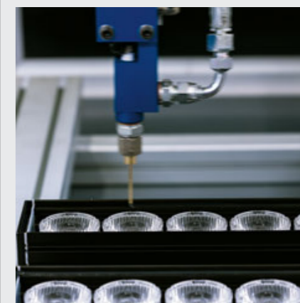
Siliconatura del diffusore Siliconing of the diffuser
